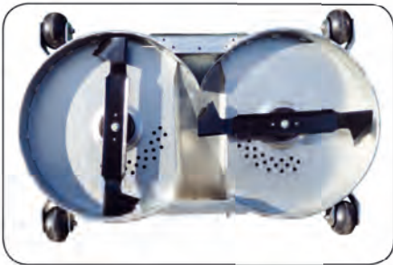
Profesionální sečení: Precizní stříh a bezproblémový sběr sečené trávy zajišťují dva synchronizované speciálně tvarované masivní nože s unikátním designem lopatek. Pozinkovaná úprava sečení zaručuje dlouhou životnost i v tom nejtěžším nasazení.
