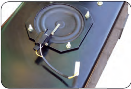
Profi hlídání naplnění: Patentovaný tlakový senzor naplnění koše.
